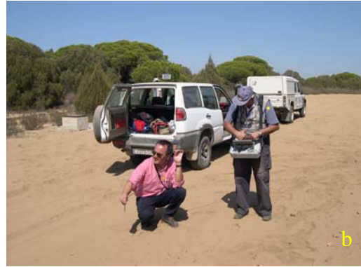
Figura 33. Medidas radiométricas en laguna de Santa Olalla (a) y arenas de mantos eólicos (b) (espectrorradiómetro ASD FieldSpec del Laboratorio de Teledetección del CEDEX)
