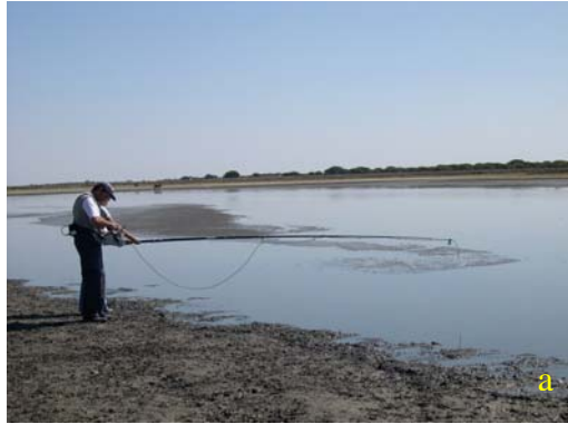
Figura 33. Medidas radiométricas en laguna de Santa Olalla (a) y arenas de mantos eólicos (b) (espectrorradiómetro ASD FieldSpec del Laboratorio de Teledetección del CEDEX)
