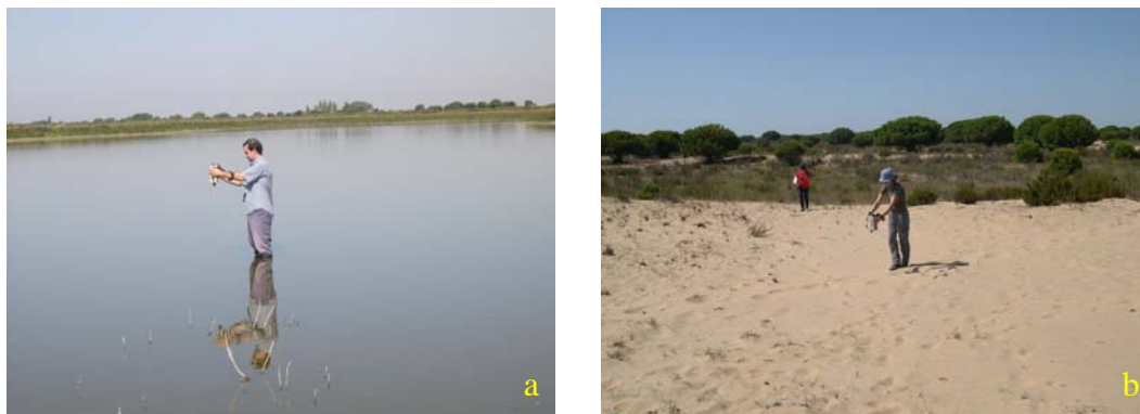
Figura 32. Medidas radiométricas en laguna de Santa Olalla (a) y arenas de mantos eólicos (b) (espectrorradiómetro GER 1500 del Servicio de Teledetección del INTA)
